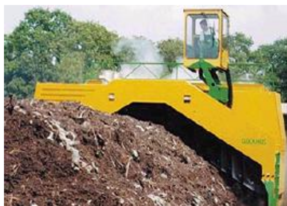
Utilaj special pentru umezire si intoarcere a compostului
